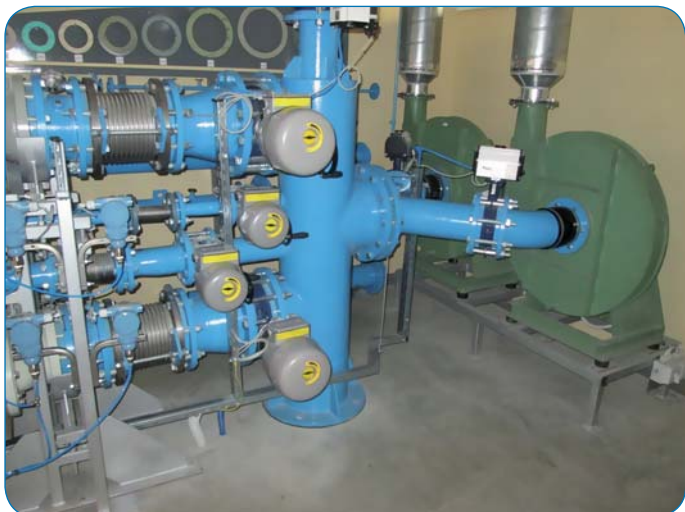
5. ábra A levegőközegű mérőpad egy része
