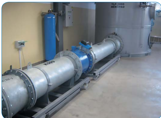
2. ábra A vízközegű mérőpad egy része
